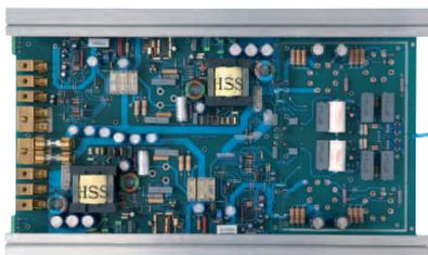
Layout interno con spessore delle piste 105 u, con visibili le sezioni dello stadio di alimentazione completamente separate per i due canali e la circuizione Dual Mono per lo stadio finale di potenza.
