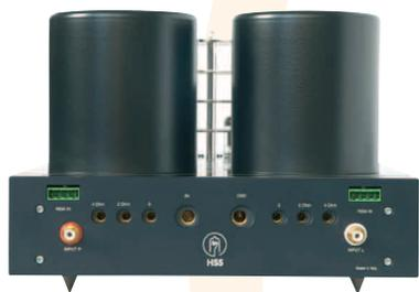
Particolare delle connessioni ingresso/uscita, con i comandi remote separati per i due canali. Da notare le generose dimensioni dei trasformatori d'uscita per le KT88.
