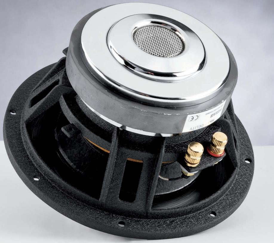
Un robusto cestello in alluminio pressofuso e verniciato antigraffio, un ampio magnete in ferrite e spesse piastre polari cromate caratterizzano la costruzione del compatto subwoofer HSW 8.
